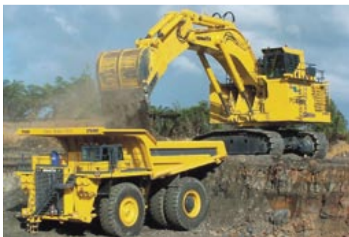
Komatsu PC 4000 in Neuseeland beim Abbau des Deckgebirges über der Kohle. Schaufelgröße: 22 m 3 , Ladeleistung: 4000 t pro Stunde
