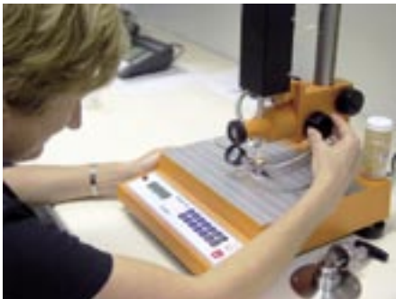
Susanne Frontczak bei der Fein-Justierung des Konus. Rechts unten im Bild: Der Fettwalker
